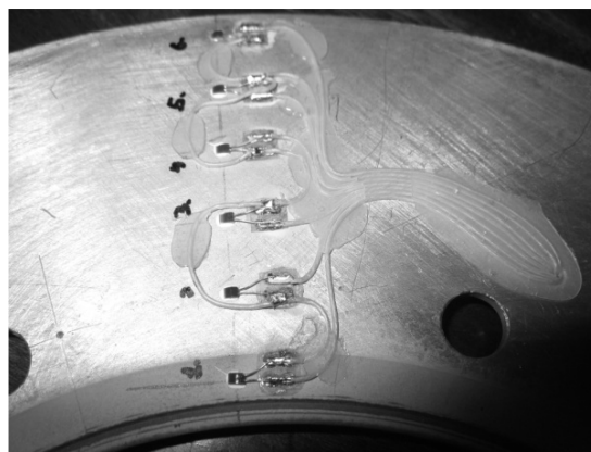
Рис.2 Расположение температурных датчиков на диске.
