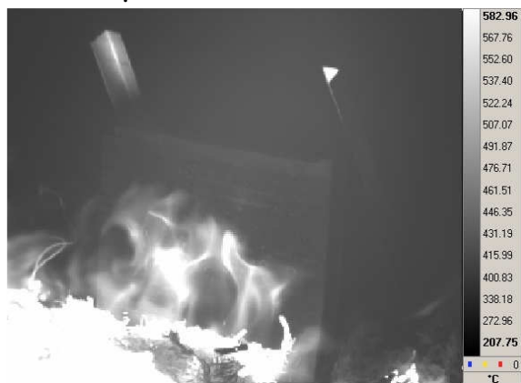
Рис. 4. Кадр тепловизионной съемки воздействия лесного пожара на плоскую деревянную стенку (спектральный интервал 2,64 – 3, 25 мкм).
