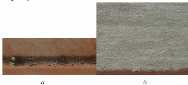
Рис. 2. Результаты взаимодействия гетерогенного потока с поверхностью кирпича: а – эрозия поверхности при типичном режиме напыления с помощью сверхзвукового сопла, б – сплошное покрытие из алюминия на поверхности кирпича.
