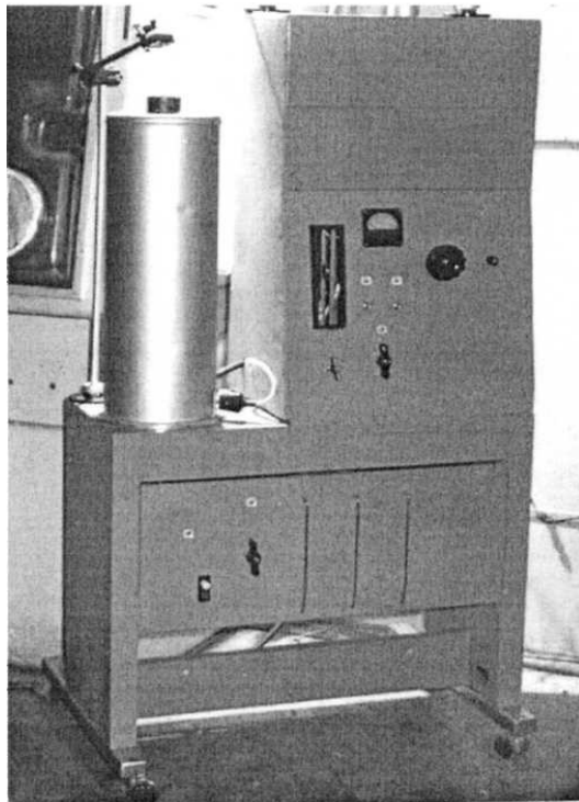
Рис.2. Общий вид экспериментального стенда для исследования сжигания топлив в КС
