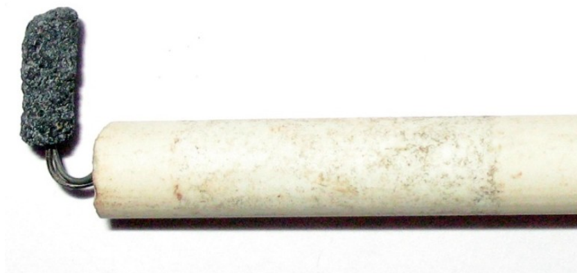
Рис. 5. Внешний вид термопары после сгорания гранулы
