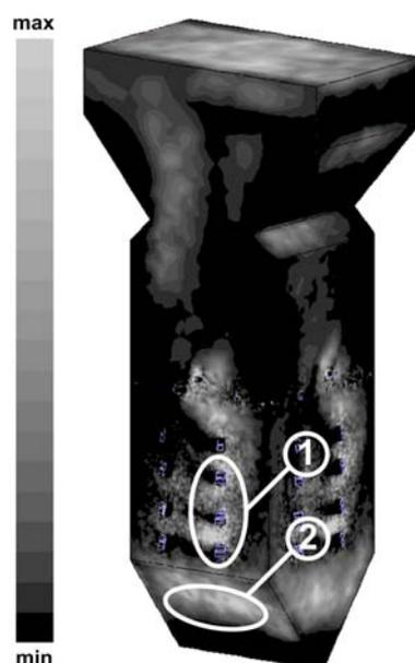
Рис. 3. Толщина слоя золовых частиц на экранах: 1) между 1-м и 2-м ярусами горелок; 2) на скатах холодной воронки.
