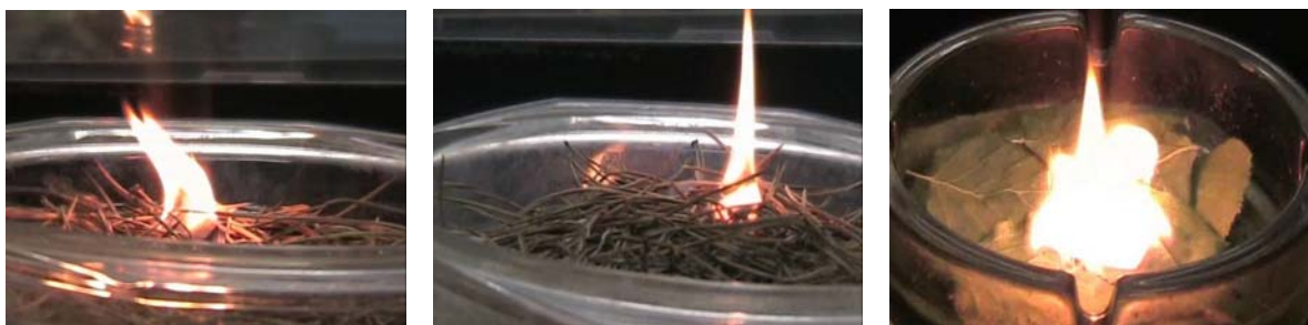
Рис. 1. Характерные кадры видеосъемки: а) зажигание хвои сосны горячей частицей ( t=0.08 с – возгорание ЛГМ, на фото видно два факела пламени – горячей частицы, второго слоя ЛГМ); б) зажигание хвои сосны нагретой до высоких температур частицей ( t=0.72 с – объединение пламени над частицей); в) зажигание листьев березы нагретой до высоких температур частицей ( t=0.2 сек – горение газообразных продуктов пиролиза и объединение факела пламени)
