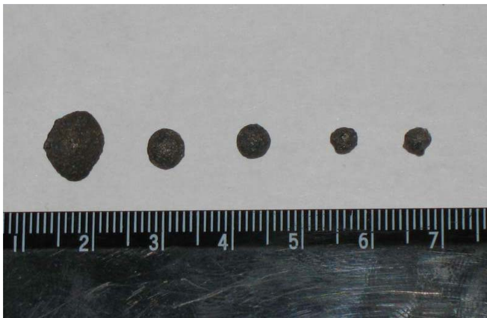
Рис. 2 - Фотография агломератов КаВУТ на основе лельчицкого бурого угля (уголь – 50%, вода – 50%), извлеченных из кипящего слоя в процессе горения.
