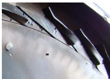
Рис. 5. Фотография направляющих рёбер, погнутых в детонационной волне, \beta = 75^\circ , одну из направляющих выбросило из гнезда (паза).
