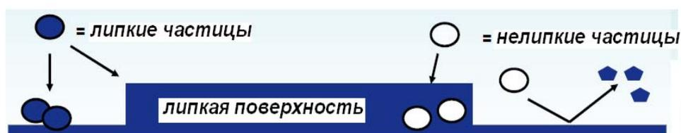
Рис. 5. Схема роста отложений по модели налипания [10].
