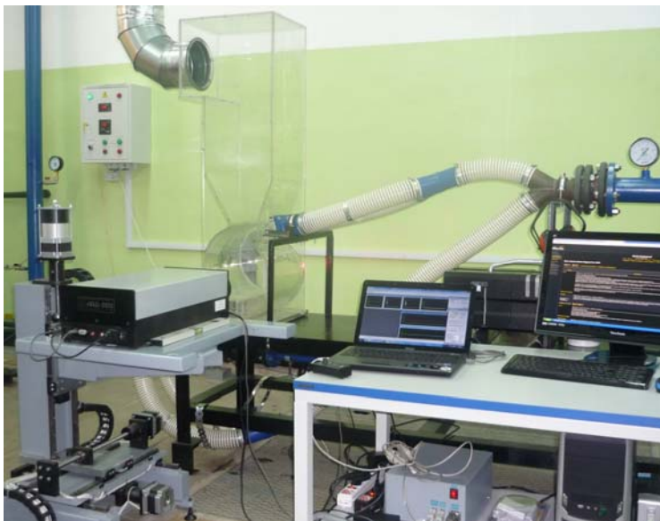
Рис. 2. Экспериментальный стенд для исследования аэродинамики в модели вихревой топки нового типа
