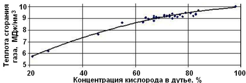
Рис. 3. Зависимость теплоты сгорания газа от концентрации кислорода в сухом дутье
