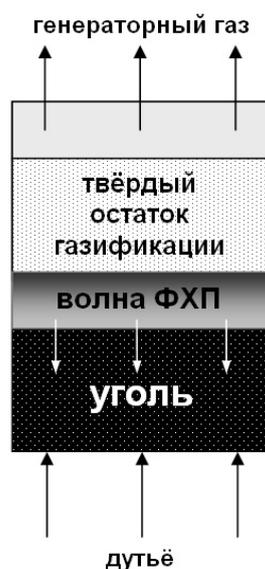
Рис. 1. Схема процессов слоевой газификации угля с обращённым дутьём «ТЕРМОКОКС-С/СГ»
