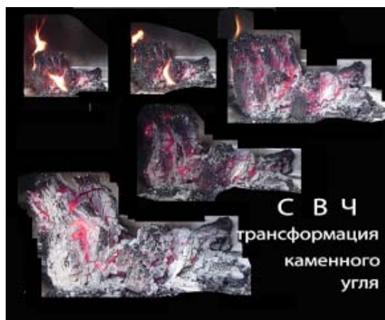
Рис. 3. Структурная периодичность возникновения факела воспламенения вдоль СВЧ инициированной трещины в угле.
