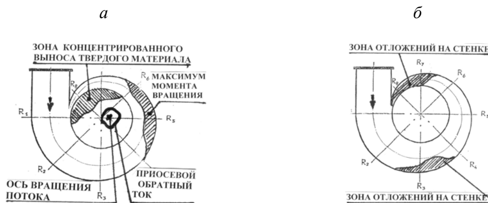
Рис. 1. Естественные деформации двухфазного вихря (а) и локализации характерных зон отложений твердой взвеси (б) в стандартной улитке
