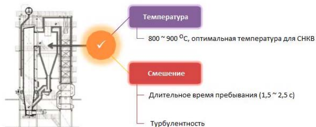
Рис. 7. Оптимальное место ввода аммиака для подавления оксидов азота
