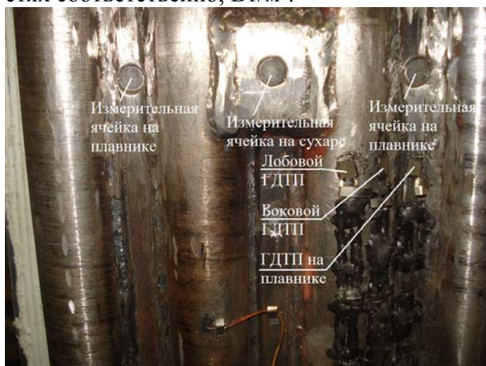
Рис. 12. Установка контрольных ГДТП и измерительных ячеек на физической модели
