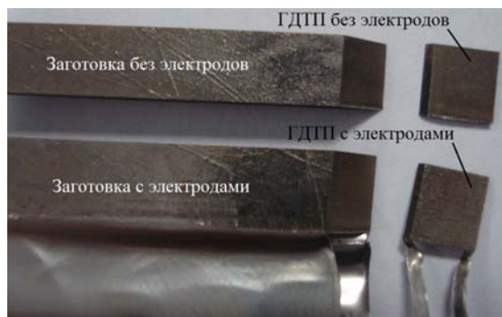
Рис. 3. Заготовка и ГДТП с электродами
