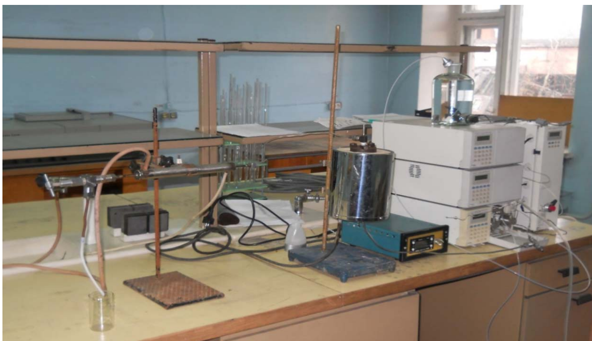
Рис. 1. Опытно-экспериментальная установка для экстракции твердого топлива.
