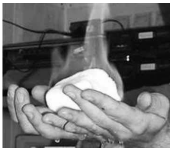
Рис. 1. Горение гидрата метана на воздухе [4].
