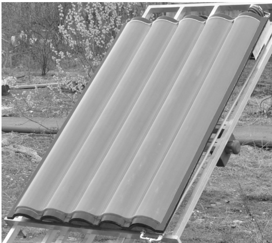
Рис. 3. Экспериментальный образец СВУ из полимерных и композитных материалов.
