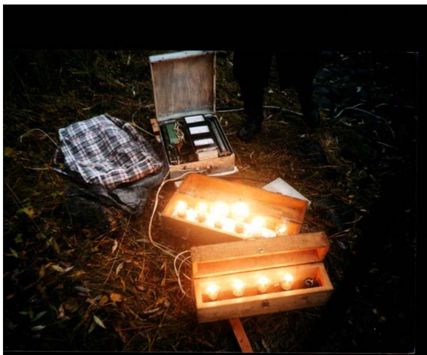
Фото 5. Береговая сеть с нагрузкой из электроламп.
