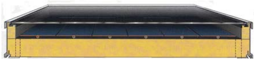
Рис. 5. Типичная конструкция плоского солнечного коллектора.
