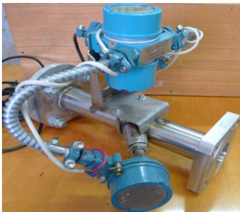
Рис 5. Рабочий образец расходомера «Кварта-Т-50». a – общий вид расходомера; б – измерительная линия расходомера.
