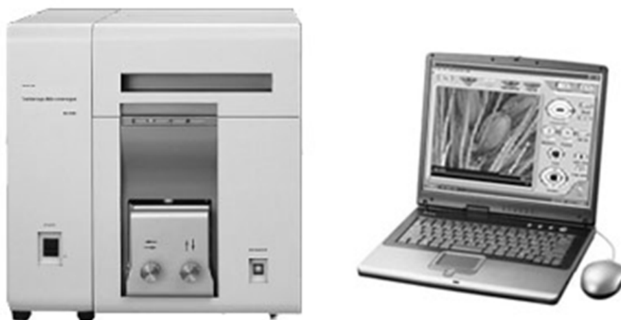
Рис. 5. Общий вид установки Hitachi TM-1000.
