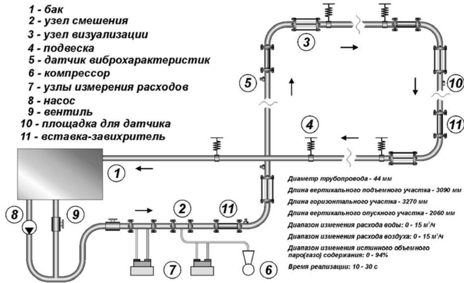
Рис. 1. Экспериментальный стенд для исследований вибраций в трубопроводах с двухфазным течением
