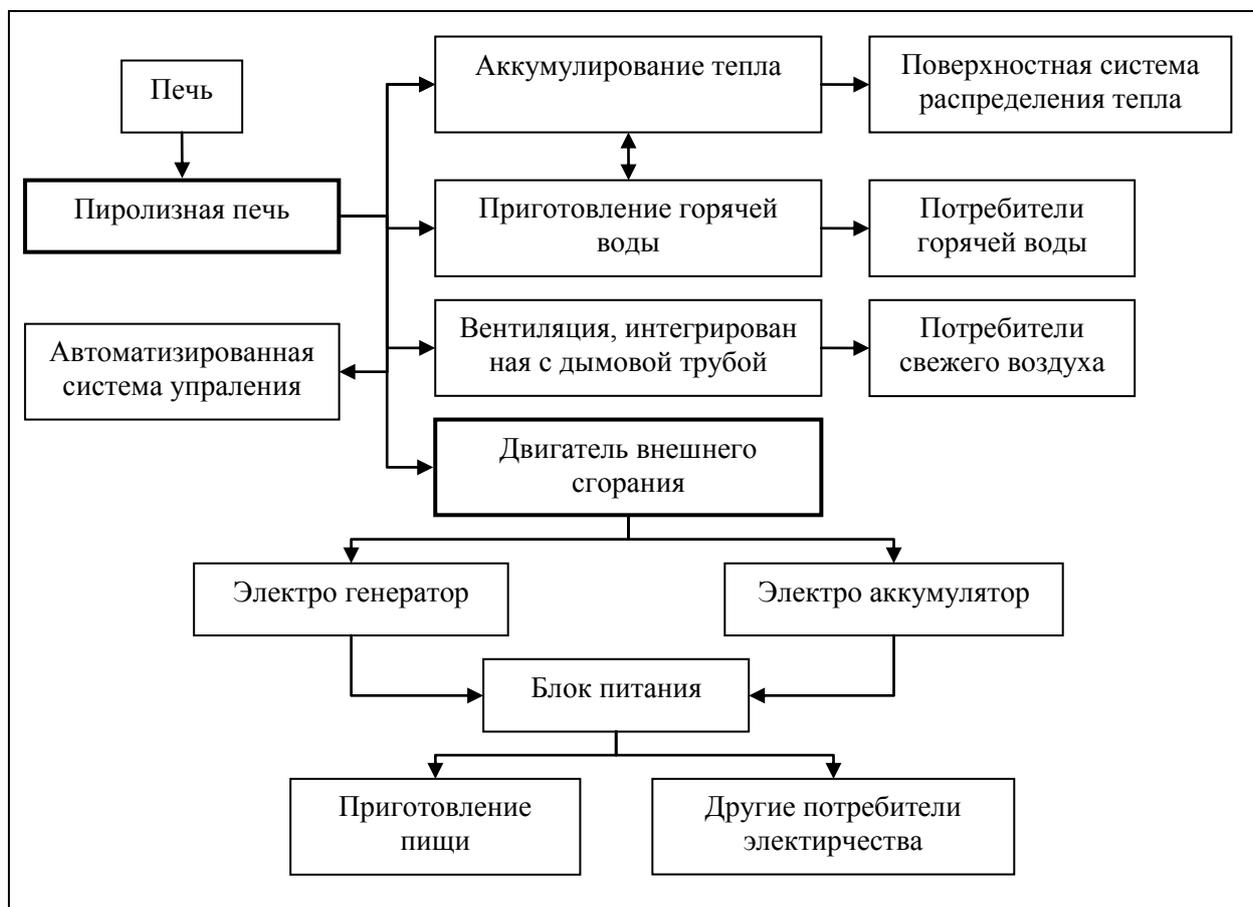
Рис 1. Система энергообеспечения индивидуального частного дома.
