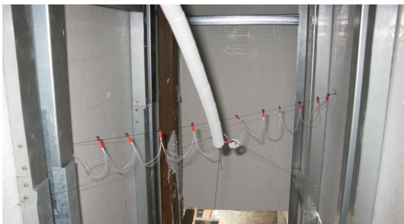
Рис. 3. Расположение системы термодатчиков внутри стены.
