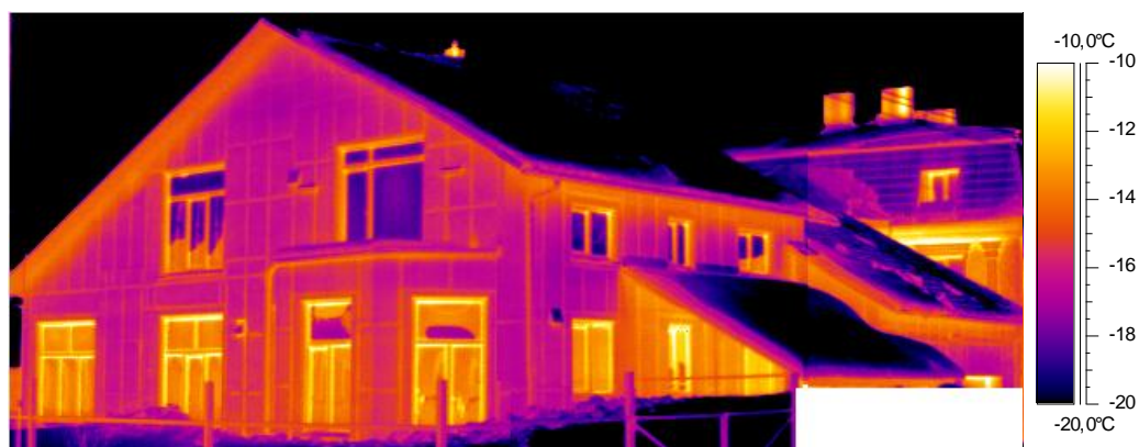
Рис. 6. Тепловизионная съемка фасада коттеджа.
