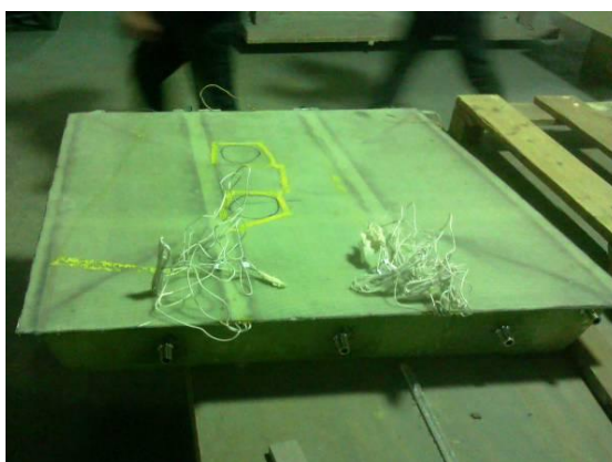
Рис. 5. Общий вид макета СВУ для исследования гидродинамических процессов и теплообмена в баке установки
