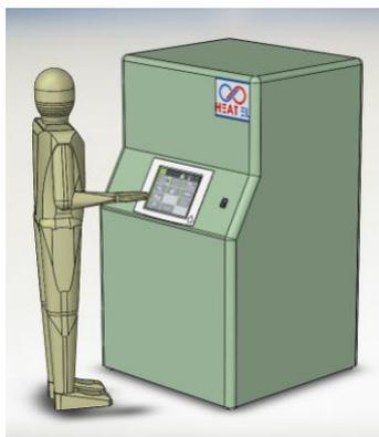
Рис. 5. Двухконтурная ОЦР-установка «Heat-El Micro» электрической мощностью 10 кВт, тепловая мощность 15 кВт.
