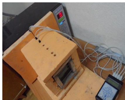
Рис. 2. Установка регулируемых температурных градиентов
