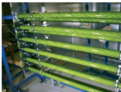
Рис. 8. Модуль выращивания хлореллы с использованием биогаза [14].
