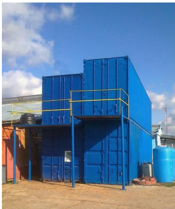
Рис. 4. Агрегаты установки. Внешний вид биогазовой установки, созданной для обслуживания по методу «Зелёного Креста», фермы на 200 голов КРС. Экспериментальное хозяйство «Кленово – Чегодаево», Троицкий Административный округ г. Москвы (рис. 4 - 7).
