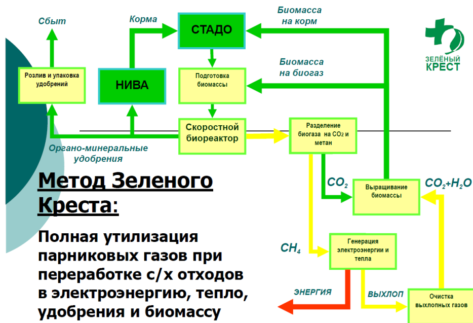
Рис. 2. «Метод Зелёного Креста» - технология комплексной переработки биodeградирующих сельскохозяйственных (животноводческих) отходов в топливно-энергетические носители (ТЭР) и удобрения.
