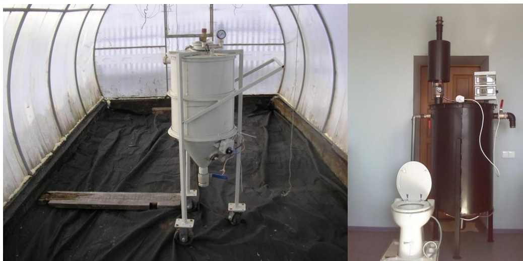
Рис.1. Оборудование утилизации и переработки фекальных отходов на 60 (слева) и 500 (справа) литров.
