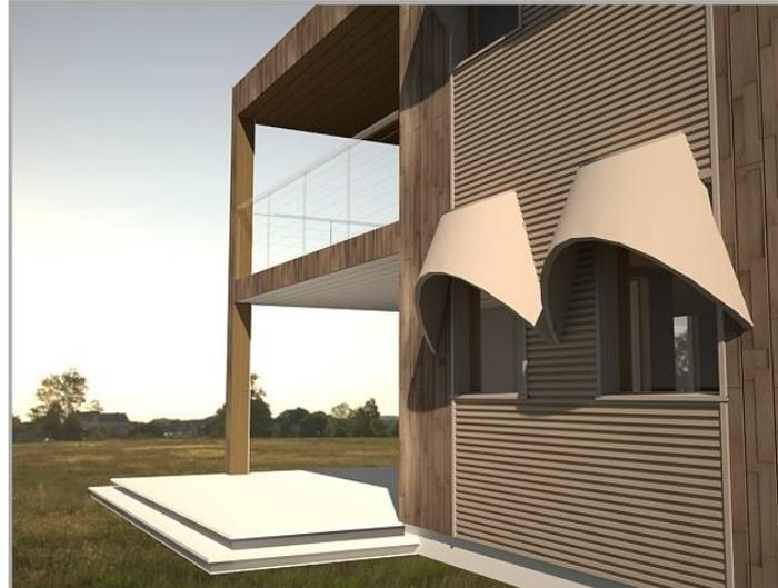
Рис. 4. Солнцезащитное устройство в виде конической поверхности
