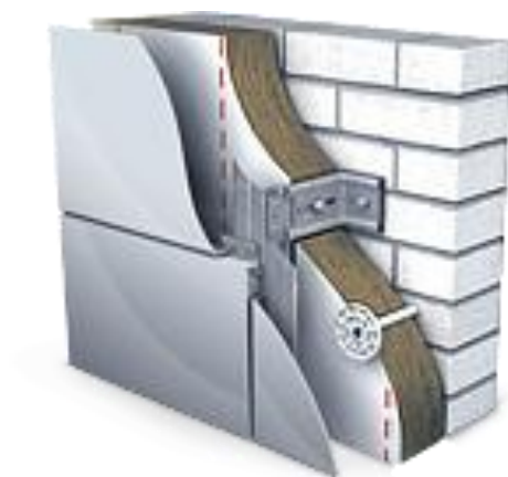
Рис. 2. Вид облицовки вентилируемого фасада (металлическая кассета).
