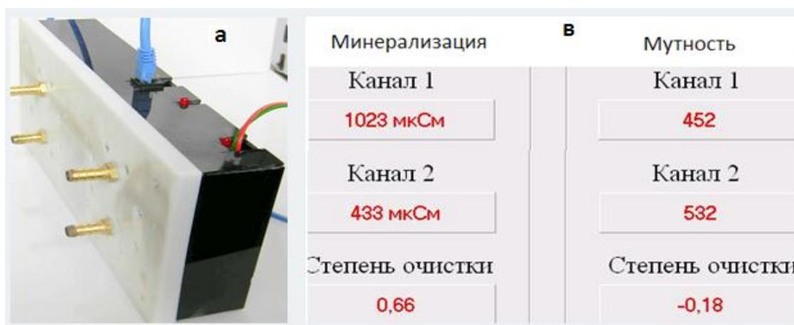
Рис. 5. Фото датчика минерализации и мутности (а), и его дисплей (в).
