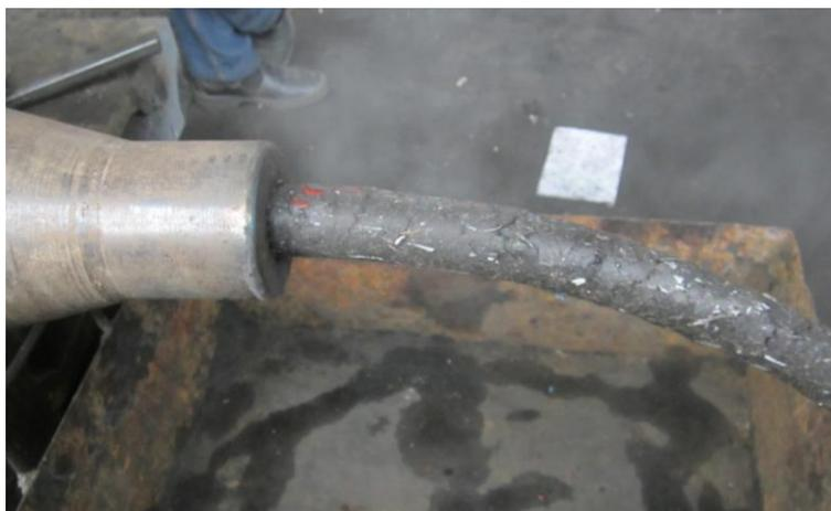
Рис.1. Процесс брикетирования измельчённого ТБО в шнековом прессе
