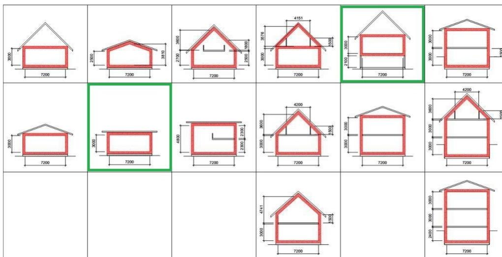
Рис. 3. Рекомендуемые схемы компоновки экодома.
