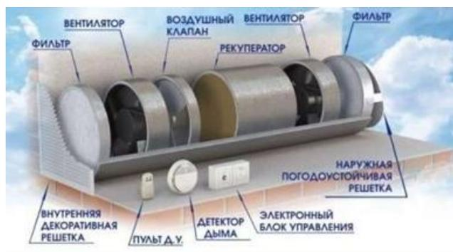
Рис. 3.1.12. Регенератор с периодическим изменением направления воздушного потока
