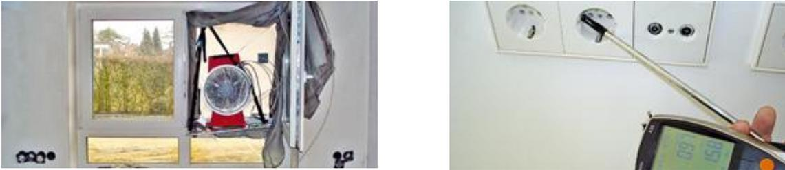
Рис. 3.1.13. Тест на герметичность
