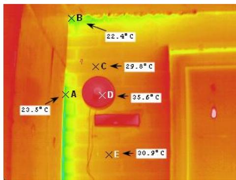
Рис. 6. Термограмма поверхности стены вблизи клапанов «КИВ-125» и «Домовент-Оптима», установленных на стене, при закрытых клапанах.
