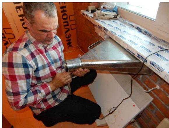
Рис.3. Измерение расхода воздуха через клапан с помощью конфузора.
