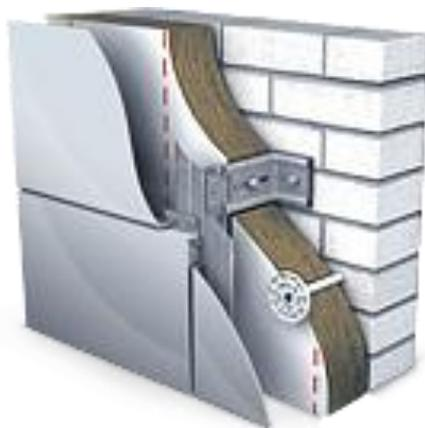
Рис. 2. Вид облицовки вентилируемого фасада (металлическая кассета).
