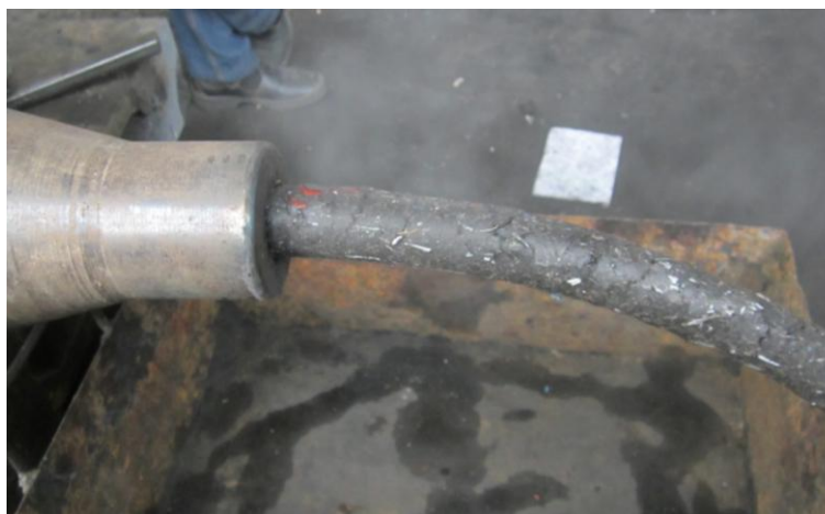
Рис.1. Процесс брикетирования измельчённого ТБО в шнековом прессе
