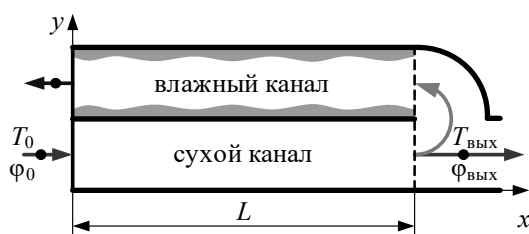
Рис. 1. Расчетная схема теплообменного аппарата.
