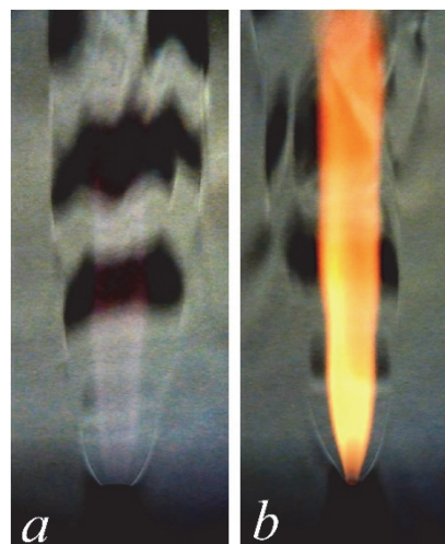
Рис. 2. Теневые картины горения круглой микроструи водорода, истекающей из круглого микросопла в отсутствие спутного потока (a) и из круглого микросопла при наличии спутной струи смеси воздуха с нанопорошком (b)
