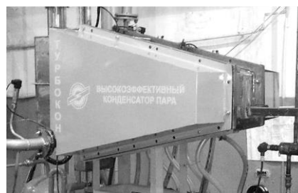
Рис. 3. Модуль высокоэффективной конденсации ПГС на стенде завода.
