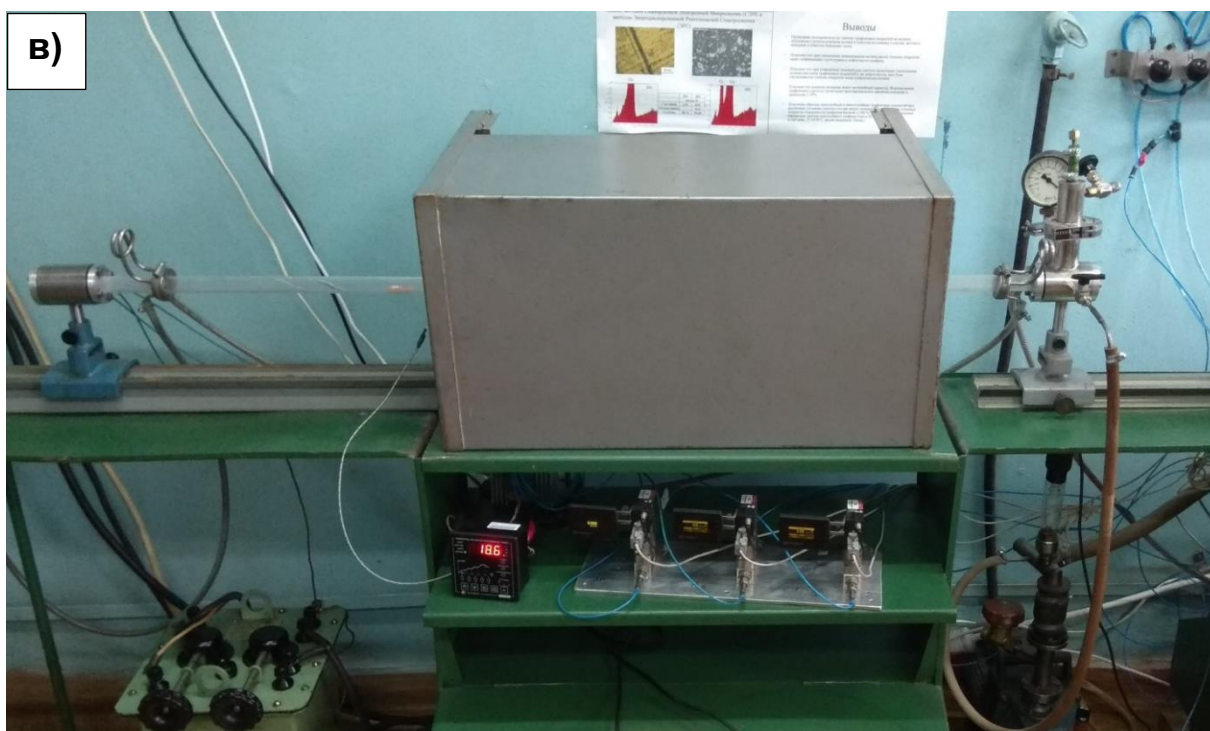
Рис. 18. (а) Схематическое изображение установки для CVD синтеза; (б) Температурные режимы, используемые во время синтеза; (в) Фотография установки для CVD синтеза.
