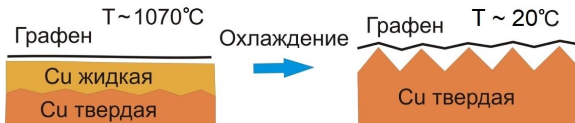
Рис. 49. Схематичное изображение смены рельефа меди при охлаждении.
