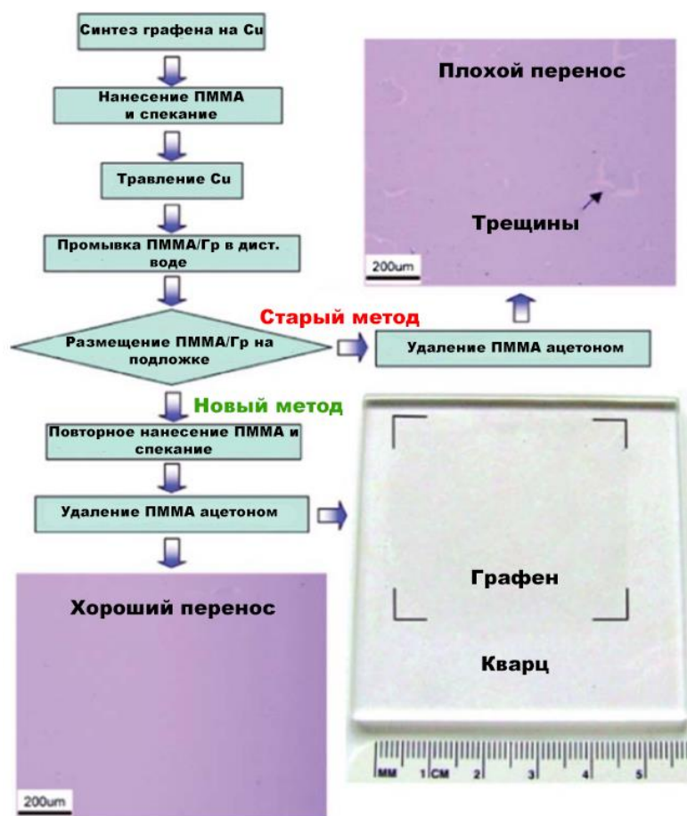
Рис. 8. Процессы переноса пленок графена с использованием двойного полимерного слоя ПММА. Изображения, полученные с помощью оптического микроскопа - справа сверху и слева снизу, показывают морфологию графеновых пленок, перенесенных на кремниевую подложку \text{SiO}_2/\text{Si} .
