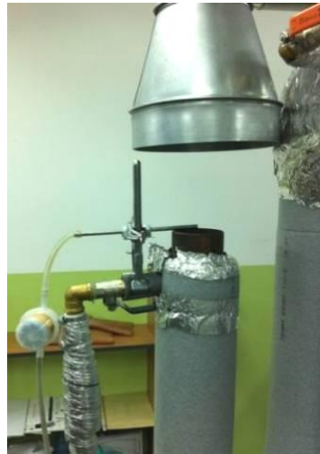
Рисунок 16. Расположение зонда газоанализатора на калориметре.
