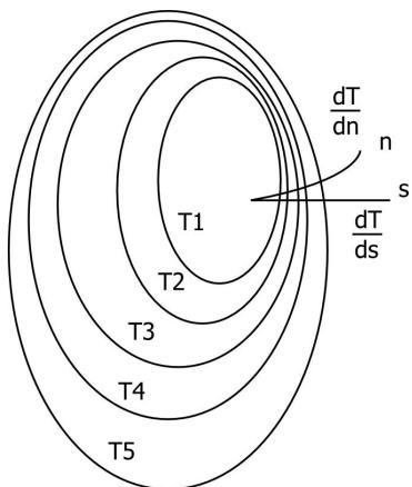
Производная температуры по нормали к изотермической поверхности называется **температурным градиентом**. Температурный градиент - векторная величина, направленная по нормали к изотерме в сторону увеличения температуры. Поэтому интенсивность изменения температуры вдоль осей координат определится проекциями температурного градиента на эти оси:
