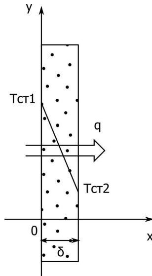
Упрощение, связанное со стационарностью процесса позволяет исключить первый член уравнения (14). Поскольку стенка является твёрдой конвективный перенос тепла отсутствует – это позволяет исключить второй и третий члены уравнения (14). Полагая, что толщина стенки намного меньше её высоты процессы теплообмена можно рассматривать только в одном направлении – поперёк стенки. Таким образом уравнение, описывающее теплопередачу через стенку можно записать следующим образом:
