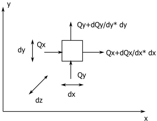
Т.к. стенки контрольного объёма проницаемы для теплоносителя, то давление внутри объёма остаётся постоянным. С учётом нестационарности процесса и связи энталпии и температуры теплоносителя, уравнение (3) можно записать в виде:
