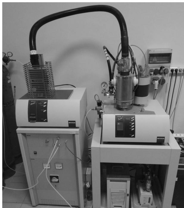
Рис. 2. – Синхронный термический анализатор, совмещенный с квадрупольным масс-спектрометром.
