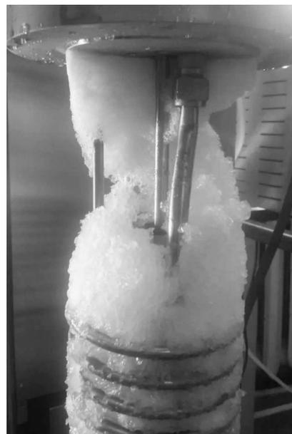
*Рис. 1 Полученный в ходе эксперимента газогидрат фреона 134а*
