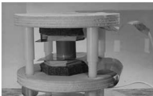
Рис. 2. Фото образца тэна в зажиме
