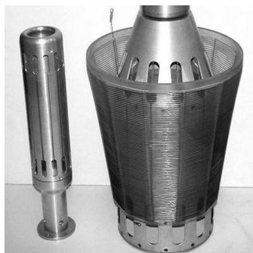
Рис. 2. Магнитопрозрачные электроды ДФЛ с незаряжаемой обмоткой  $L_2$ .
