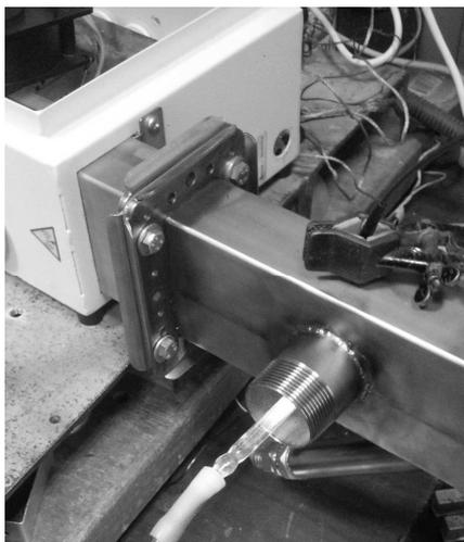
Рис. 1. СВЧ разряд в кварцевой трубке (горизонтальное расположение).
