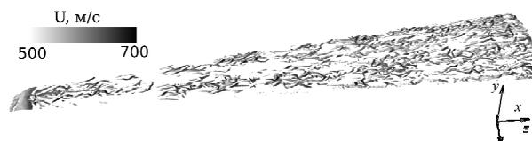
Рис.2. Изоповерхность  $Q$ -критерия и контуры скорости:  $R=5\text{мм}$ ,  $Re_l=37.8 \times 10^6 \text{м}^{-1}$ ,  $M_\infty=5.95$ ,  $P_0=26.5\text{Па}$ ,  $T_0=369\text{К}$ ,  $k=0.6\text{мм}$ ,  $d=0.3\text{мм}$
