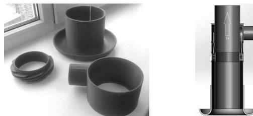
Рис. 2. Фотография и схема экспериментальной установки
