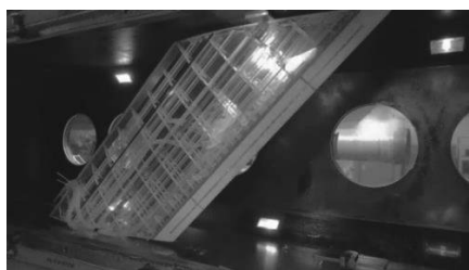
Рис. 1 Модель скользящего крыла в рабочей части Т-324.
