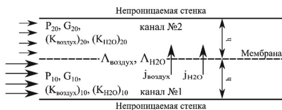
Рис. 1. Схема течения влажного воздуха в мембранном прямоточном теплообменнике.
