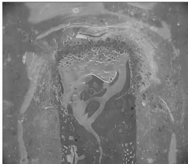
Рис. 1. Фотография кризиса в двухфазной системе с локальным источником нагрева. U_{sq}=12,3 м/с, U_{sl}=0,026 м/с, общая мощность нагревателя q_{cr}=101,2 Вт.
