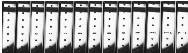
Рис. 2. Деформация пузырька после развития ЧР.
