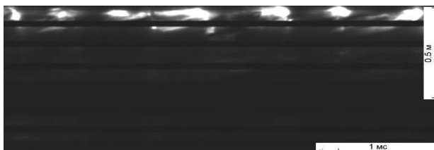
Рис. 1. Фрагмент фоторегистрограммы ПДВ в смеси \text{CH}_4 + 2\text{H}_2 -воздух с K_{\text{ex}} = 1.77 ( G_a = 20.8 кг/с, \phi = 1.01 , n = 2 , f = 1.34 кГц, D = 1.06 км/с).
