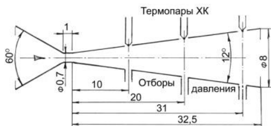
Рис. 1. Параметры диффузорной части сопла.
