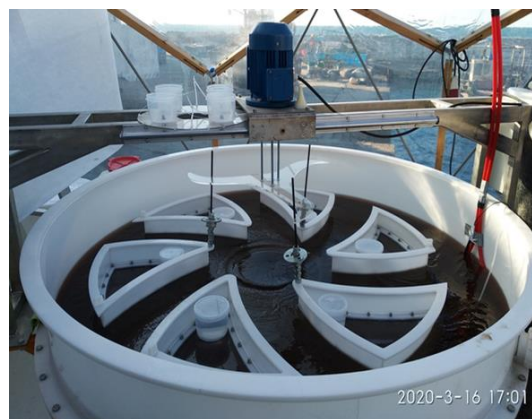
Рис. 1. Фотобиореактор малой глубины для культивирования микроводорослей.
