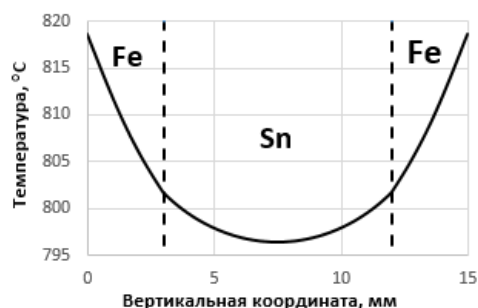
Рис.2 Распределение температуры в реакционной зоне по высоте.
