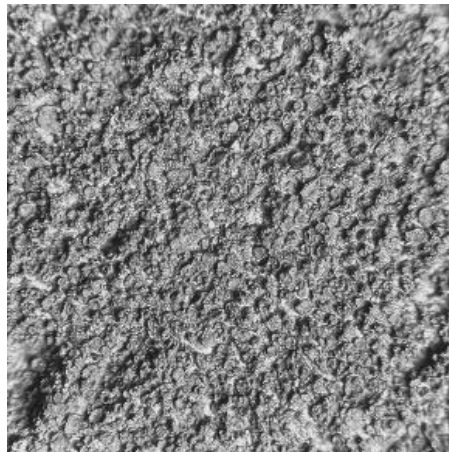
Рис. 1 – гидрофобное покрытие на основе наночастиц углерода на поверхности алюминия. Увеличение ×1500.
