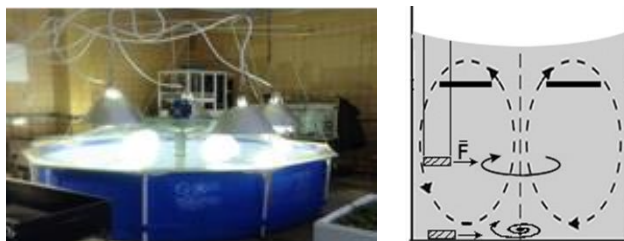
Рис. 1. Общий вид промышленного газовихревого фотобиореактора, объём 580 л, разработка ООО «Водорослевые технологии» г. Новосибирск (слева) и схема вихревого движения в нем (справа).
