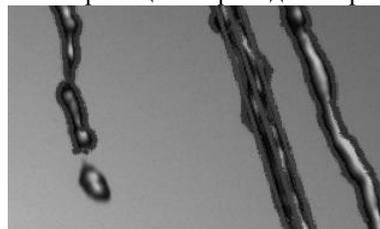
Рис. 2. Пример обработанного изображения. Границы выделены жирными линиями. Для центральной струи так же линиями выделены направляющие прямые.
