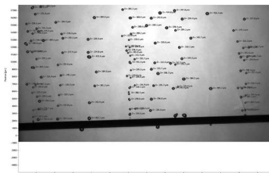
Рис. 1. Кадр высокоскоростной съёмки с определенными размерами пузырьков
