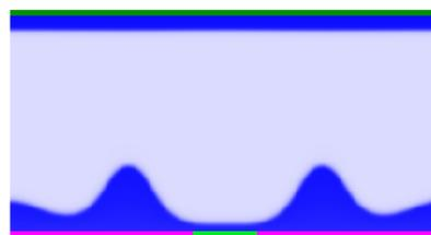
Рис. 2. Деформация плёнки жидкого диэлектрика при воздействии неоднородного электрического поля в процессе перфорации.  $t = 28000$ .
