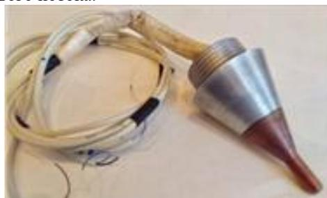
Рис. 2 Датчик теплового потока ДТП-ГД-2.
