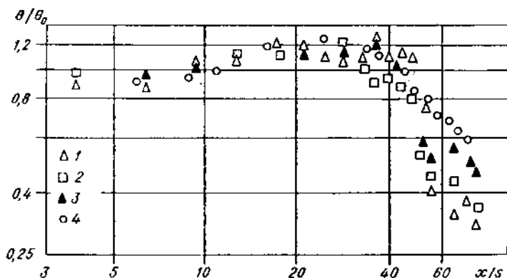
Рис. 4.18. Относительное изменение эффективности газовой завесы в соплах при течении с перерасширением потока.
