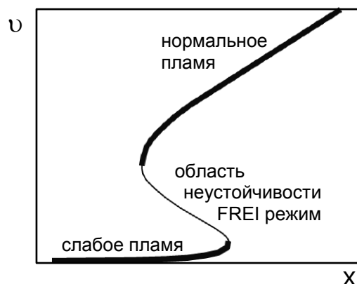
Рис. 11. Зависимость координаты положения пламени относительно заданного профиля температуры стенок микроканала от скорости газа. Жирной линией отмечены области устойчивого горения
