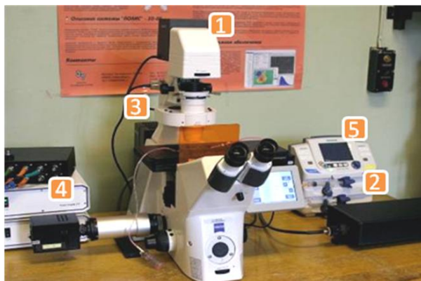
Рис. 1. Фотография экспериментальной установки для проведения micro-PIV и micro-LIF измерений.
