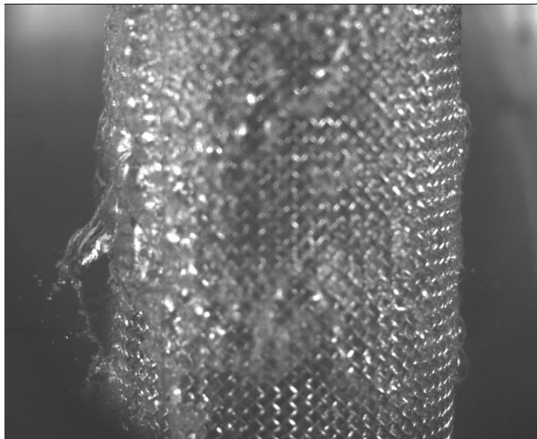
Рис. 3.44. Кипение на трубе с сетчатым покрытием № 2,  $q = 3.1 \text{ Вт/см}^2$ ;  $Re = 210$ .
