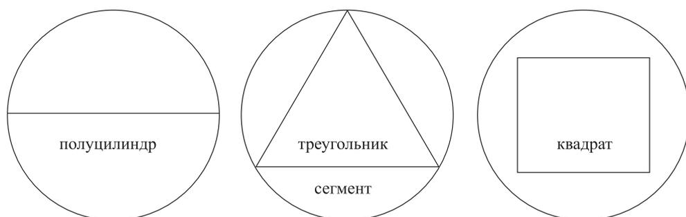
Рис. 4.40. Формы поперечного сечения колонн с разделительными стенками.
