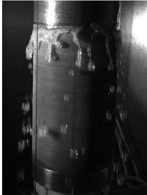
Рис. 3.51. Осушение микроструктурированной поверхности.  $Re = 105$ ;  $q=9.1$  Вт/см<sup>2</sup> [214].
