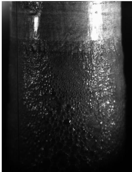
Рис. 3.40. Кипение на микроструктурированной поверхности.  $Re = 105$ ;  $q = 3.5 \text{ Вт/см}^2$ .
