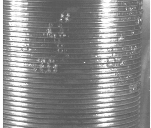
Рис. 3.21. Образование сухого пятна в режиме испарения. Оребренная поверхность,  $Re = 26$ ,  $q = 1.5 \text{ Вт/см}^2$ .
